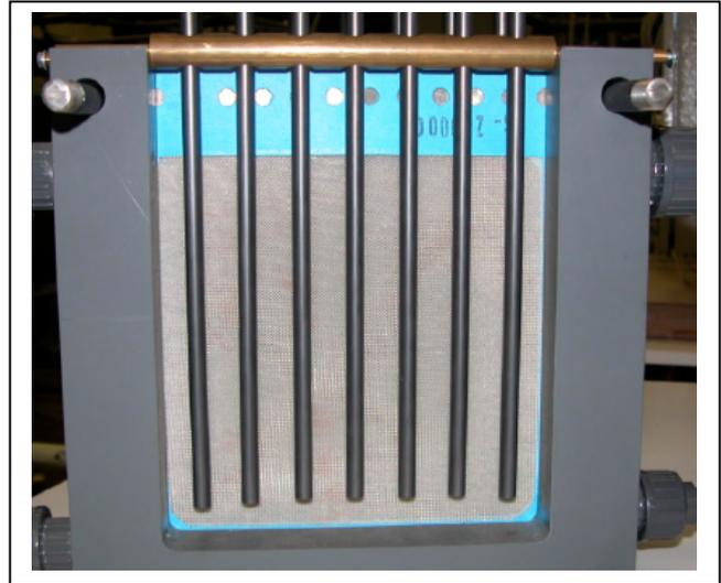
**Testanlage zur elektrolytischen Rückgewinnung von Metallen und anodischer Oxidation von Abwasser-Inhaltsstoffen.
