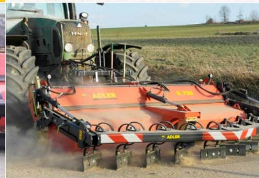
Aufnehmende Kombination mit der Kehrmaschine K 750
