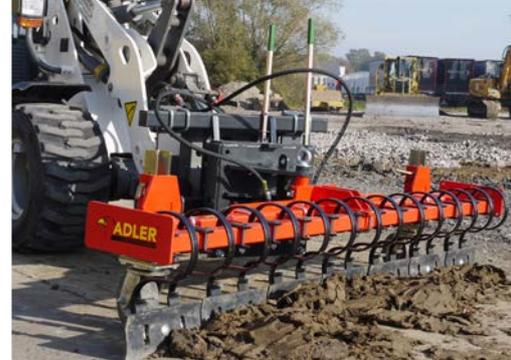
Direktanbau an Schlepper oder Radlader
