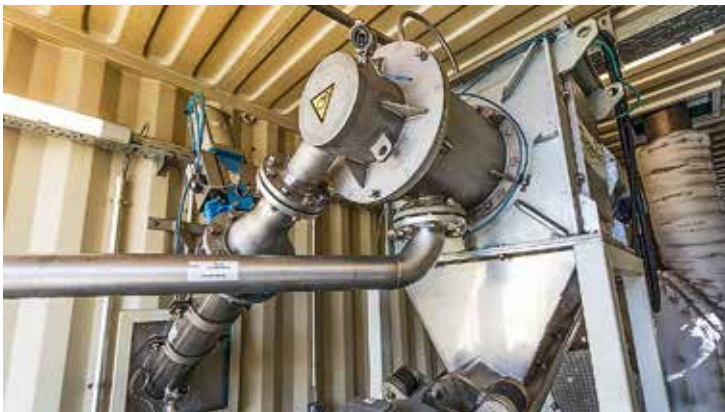
Der Regenis GT 200 separiert ca. 1,5 bis 1,8 m 3 Gärrest pro Stunde.
