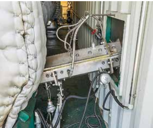
Bei Überhitzung sprühen Düsen am Austrag automatisch kaltes Wasser ins getrocknete Material.
