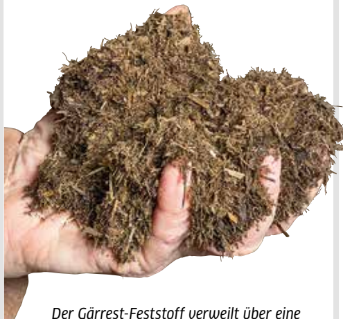
Der Gärrest-Feststoff verweilt über eine Stunde bei 75 bis 90 °C im Trockner. Danach ist das Material auch hygienisiert.
